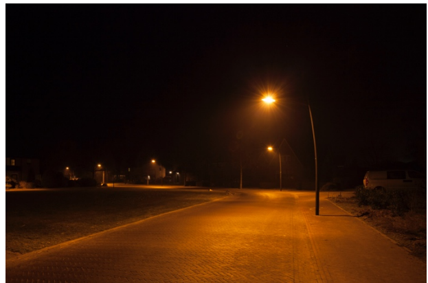
Foto rechts: Verlichting die alle kanten op schijnt. Het lijkt meer licht, maar er is minder licht op de weg.
